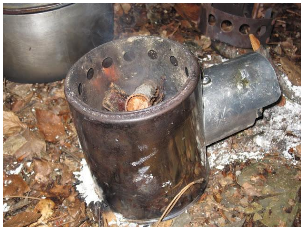
108. Самодельная печка с вентилятором.
